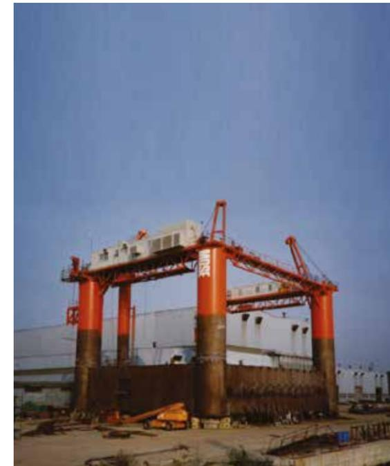
Tra le referenze di maggior pregio in questo settore, Idromacchine può vantare la costruzione, il montaggio e il varo dalla banchina nel proprio stabilimento del prototipo del "MO.S.E.", Il Modulo Sperimentale Elettromeccanico per la regolazione delle acque della laguna di Venezia, di cui Idromacchine possiede i brevetti relativi ai vincoli di snodo.
