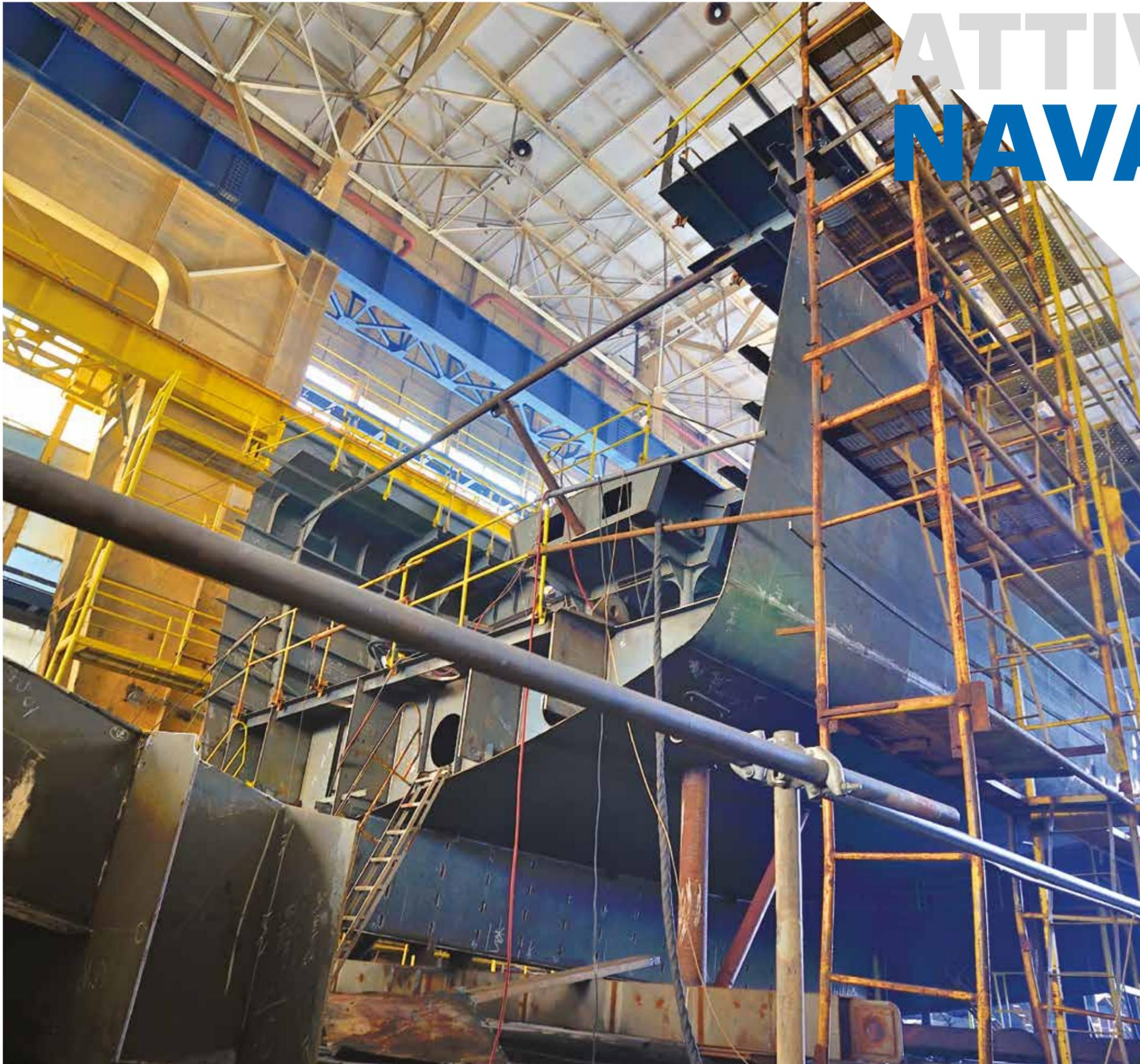
*Nel settore navale Idromacchine opera con ampio raggio di azione. Impresa autorizzata alla costruzione di navi e di galleggianti, è in grado di fornire "chiavi in mano" unità navali specializzate, sezioni e blocchi prefabbricati e preallestiti direttamente dal proprio stabilimento, pronti per l'assiemaggio nel bacino delle società committenti, impiantistica di bordo meccanica, elettrica e strumentale.*
